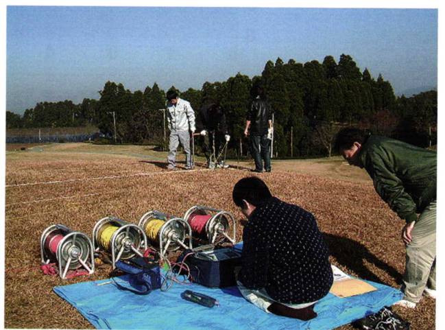
図10 岩原双子塚古墳の後円部で実施した比抵抗法探査の実施風景
