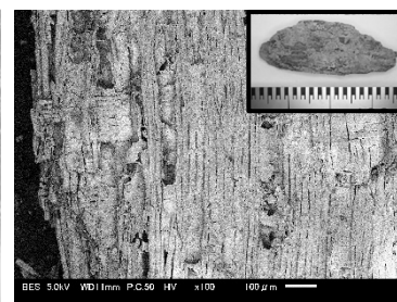
写真4 鞘木材片破断面のSEM画像 右上：脱した木片
