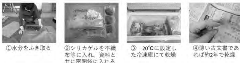
図1：乾燥の方法と工程
