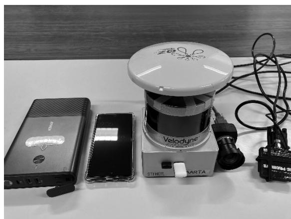
写真3 ハンドヘルド型 LiDAR 機器との接続
