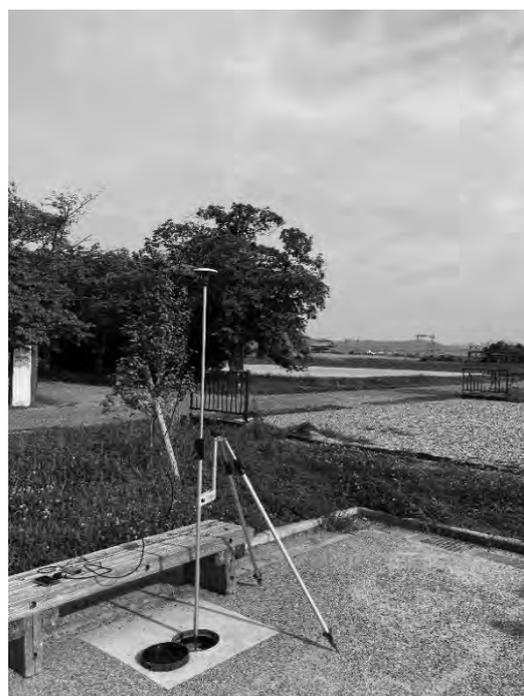
写真 1 3 級基準点の計測試験
