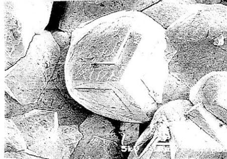
図 6 剥離面に観察されたマグネタイトの結晶
