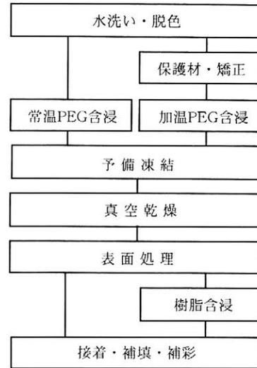
図1 処理工程
