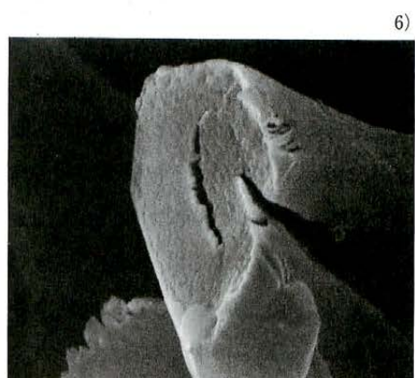
写真6 芯糸の単繊維の走査型電子顕微鏡写真
