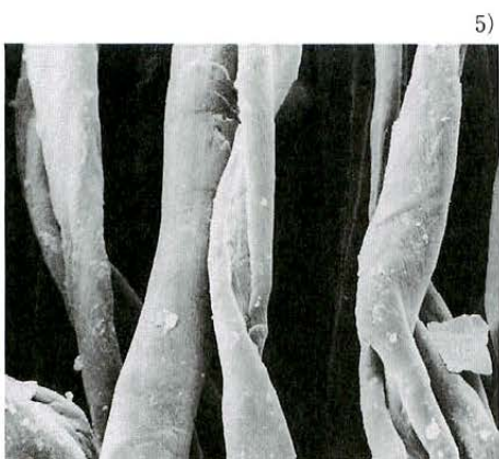
写真6 芯糸の単繊維の走査型電子顕微鏡写真
