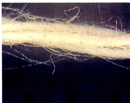
写真2 CCDカメラによる試料糸の写真
