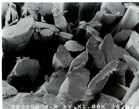
写真5 C糸及びB-2糸の走査型電子顕微鏡写真
