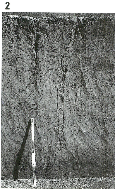
図版 2 相模原市古淵B遺跡の地割れとテフラの液状化跡
