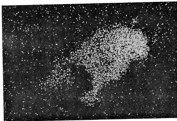
写真3. 薬師寺月光菩薩像鉄心の非金属介在物
