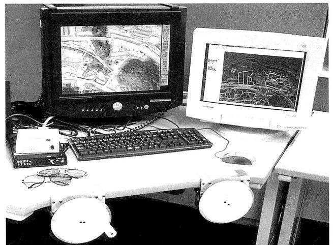
図3 PC 図化機による地図作成
