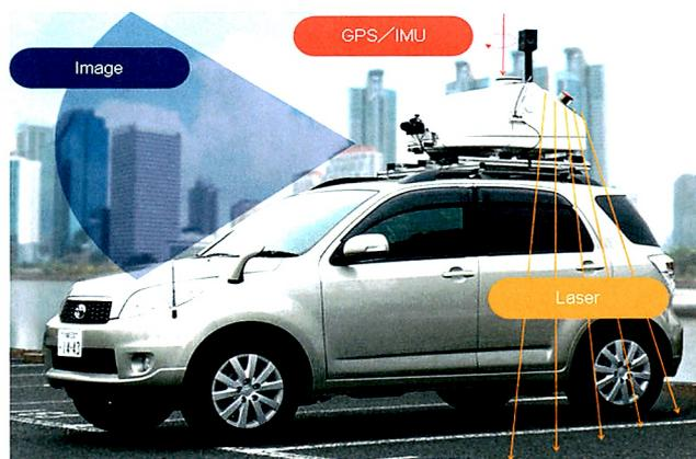
図 35 モバイルマッピングシステム (MMS)
