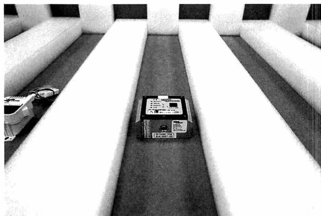
Photo.4 The acceleration data logger set on the packaging box. 梱包箱に設置した加速度データロガー
