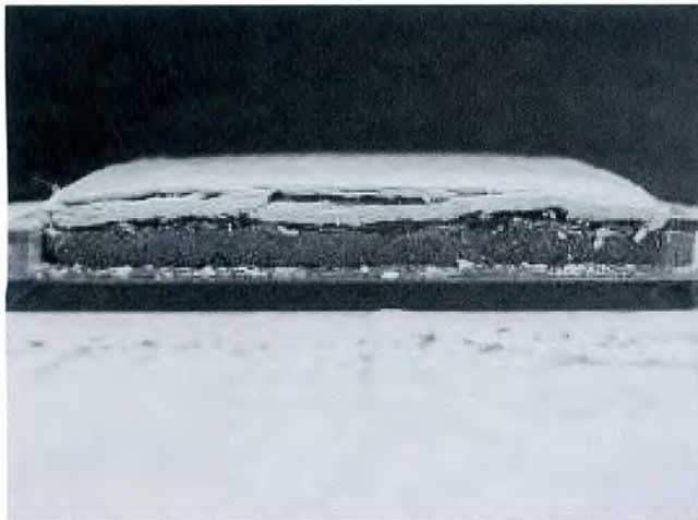
図 15 水供給方向から見た劣化促進実験後の試験片 A の断面；漆喰層の一部が基層から剥離するとともに、漆喰層自身が層状に剥離している Fig. 15 Cross section of test piece A after the accelerated ageing experiment, observed from the underside where water supplied
