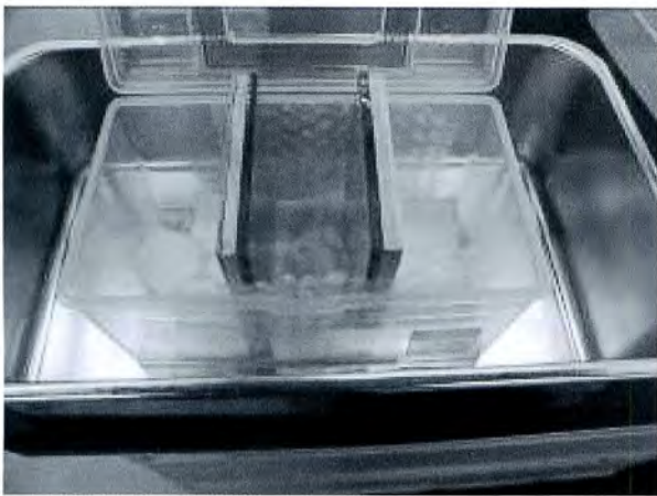
図10 試験片を用いた劣化促進実験の様子
