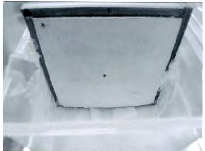
図13 劣化促進実験後の試験片A
