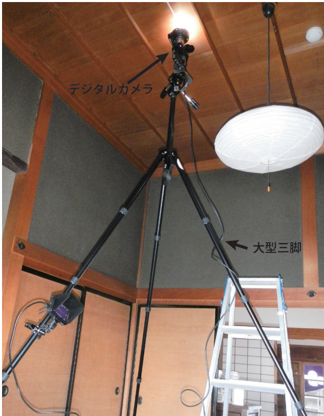
図2 デジタルカメラによる天井板の撮影。カメラはタブレット端末から遠隔操作が可能である。
