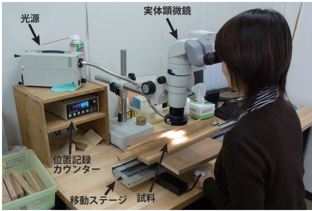
図1 ベルメックス年輪計測器。実体顕微鏡の片方の接眼部には、十字線が装備されている。(米延仁志氏提供)
