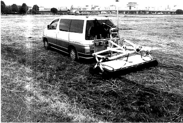
図9 アレイ式地中レーダー機器の計測試験風景 Fig. 9 A vehicle-towed GPR array.
