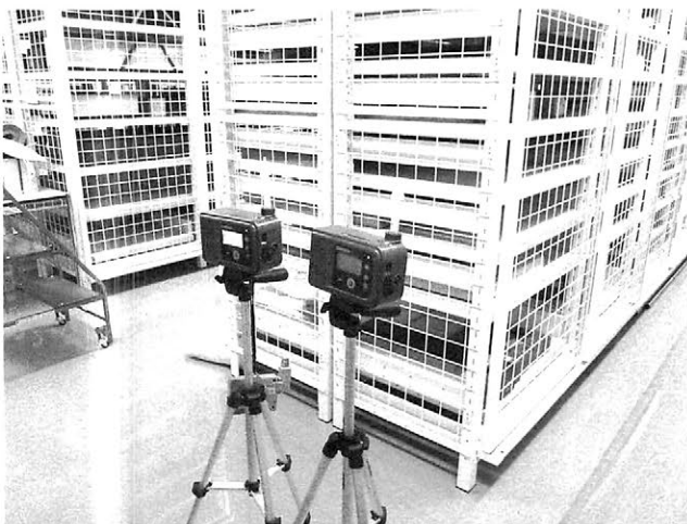
写真6 取蔵庫内の空気汚染物質調査 Photo 6 Investigation of air pollution in storage.
