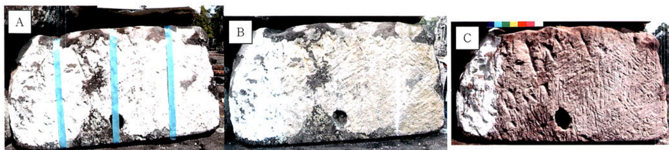
図3 光合成阻害剤による着生生物の除去試験
