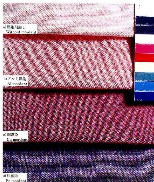
写真2 アルミ、銅、鉄を媒染剤に用いたスオウ染めの 絹布（現代） Photo.2 Modern silk fabric dyed with Brazilwood using Al, Cu or Fe as mordant
