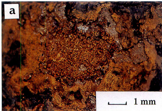
図6 腐食促進テストをした鉄板に形成された腐食生成物 (NaCl3%水溶液につけた後、一週間、25°C・RH70%の空气中に暴露した) (a) 柱状の密集部分 (b) 柱状の腐食生成物
