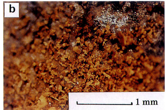
図6 腐食促進テストをした鉄板に形成された腐食生成物 (NaCl3%水溶液につけた後、一週間、25°C・RH70%の空气中に暴露した) (a) 柱状の密集部分 (b) 柱状の腐食生成物
