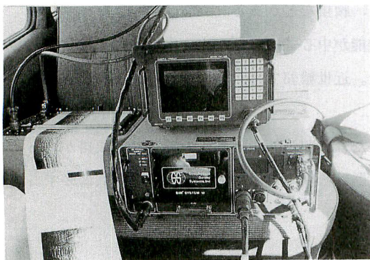
写真4-1-1 地下レーダー探査装置
