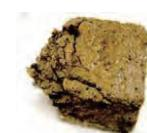
図 7. 撥水層の破壊
