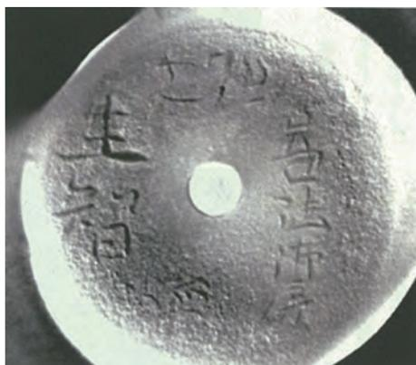
図 3 額安寺忍性骨蔵器の高台上面の CT 画像（局面を平面に展開）
