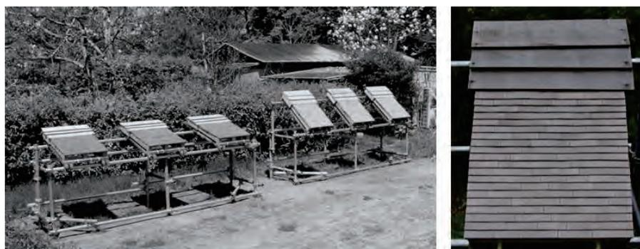
図1 こけら葺屋根モデルの屋外暴露状況
