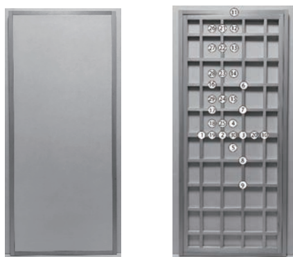
図1 製作したレプリカ(長 1149/幅 501/厚 19.5mm)と計測位置を骨組み上に表示したもの。
