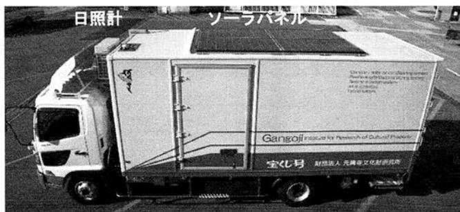
写真1 環境適応型文化財輸送診断車（シバラⅡ号）外観
