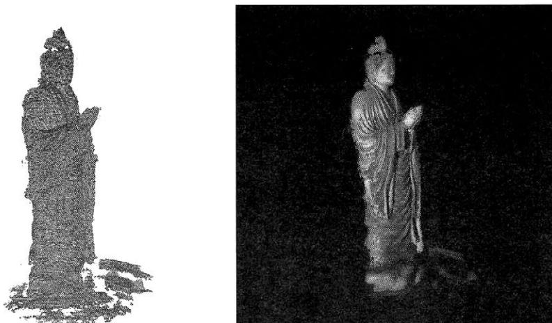
図 2. 東大寺法華堂安置仏像の計測結果例。点群データ(左), テクスチャ貼付済ポリゴンデータ(右)
