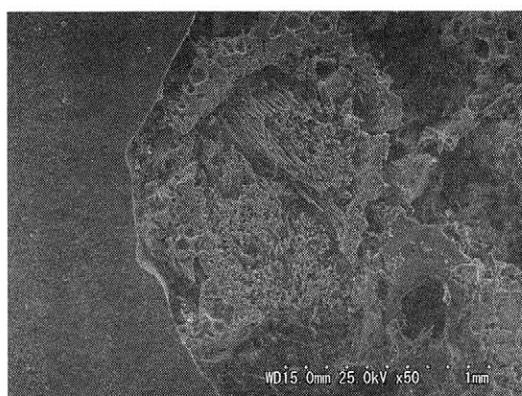
図 3：糸断面の SEM 像
