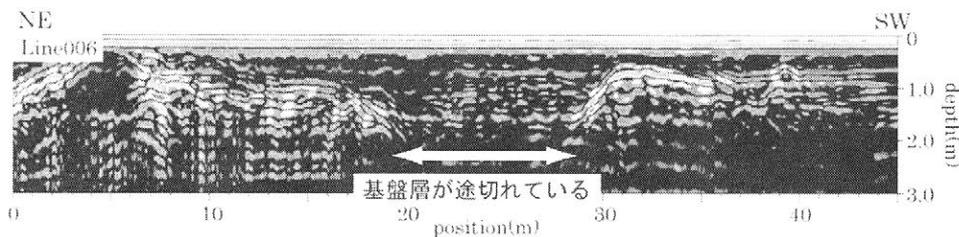
図4 丘陵南斜面で得られた代表的なGPR プロファイル
