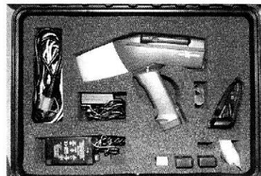
図1 ハンドヘルド蛍光X線分析計 Innov-X $\alpha$  4000
