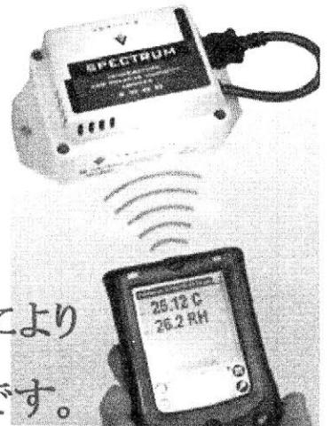
ベリテック社赤外線無線データロギングシステムを導入すれば、PDAの赤外線通信機能を利用し、ガラスケース等の外側からサンプリングしたデータを収集することが可能になります。
