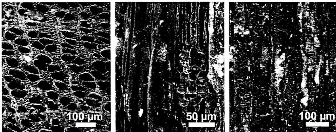
ミズキの SEM 写真 (左から木口面・まさ目面・板目面, 反射電子像)
